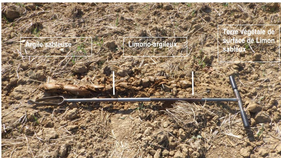
Photo du sondage 5 en exemple, profondeur prospectée : 90 cm
